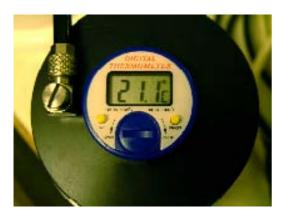
Мониторинг температуры тестовой жидкости проводится непрерывно с помощью термометра. Он представляет собой компактный блок, работающий от батареек. Питание дисплея отключается через 10 минут простоя прибора с целью экономии потребляемой энергии. Батареек обычно хватает на 5000 часов работы. Вернуться к отображению информации на дисплее можно одним нажатием клавиши ON/OFF.
